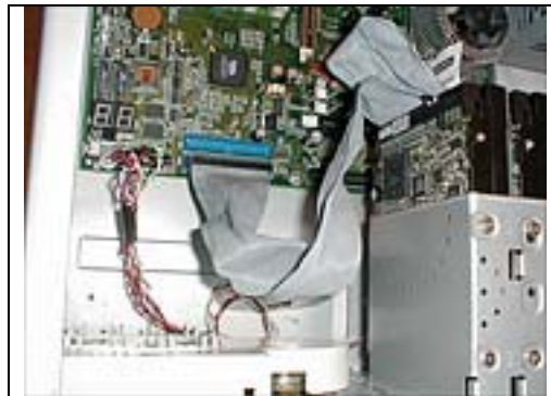
اتصال کابل های ریبون IDE هاردرایو
